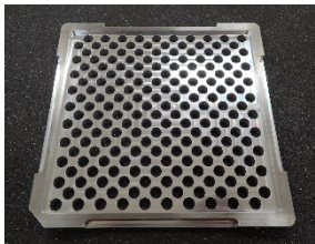
図3：多孔品のワイヤー放電加工
