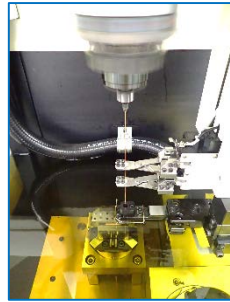
図2：細穴放電加工機 硬い材料のスタート穴加工に使用します。
